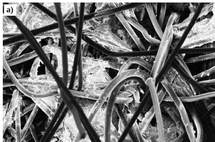
Rys. 7. Zdjęcia skaningowe osadu bentonitu odłożonego w geowłókninie G1 (po lewej) oraz kaolinu odłożonego w geowłókninie G2 (po prawej) wykonane przy powiększeniu 250 razy (po lewej)
