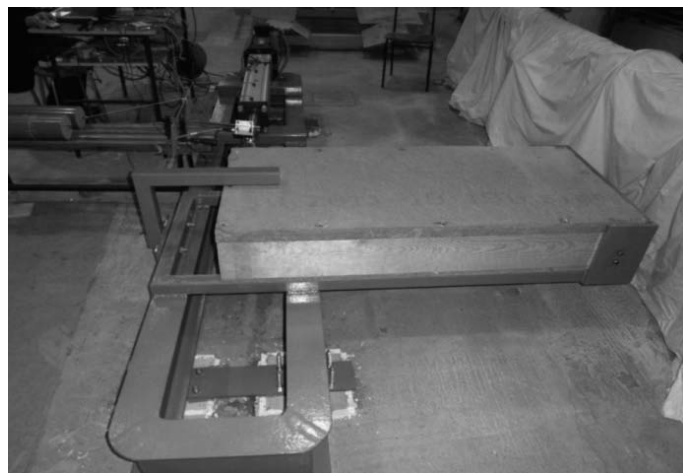
Rys. 1. Widok stanowiska badawczego z zamocowanym elementem ściennym
