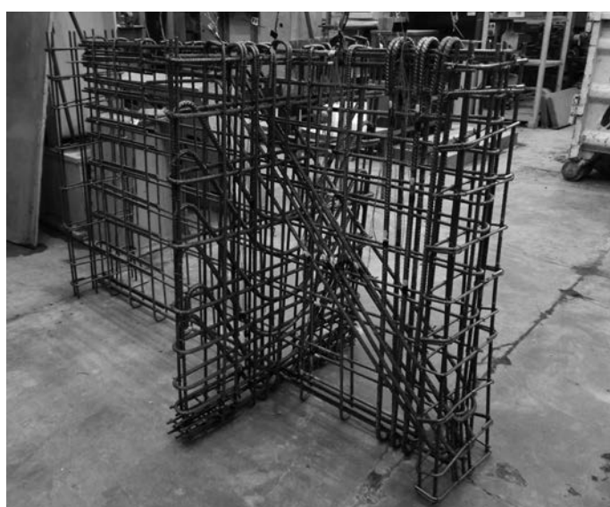
Rys. 4. Zbrojenie tarczy DB-II (z dodatkowym zbrojeniem ukośnym)
