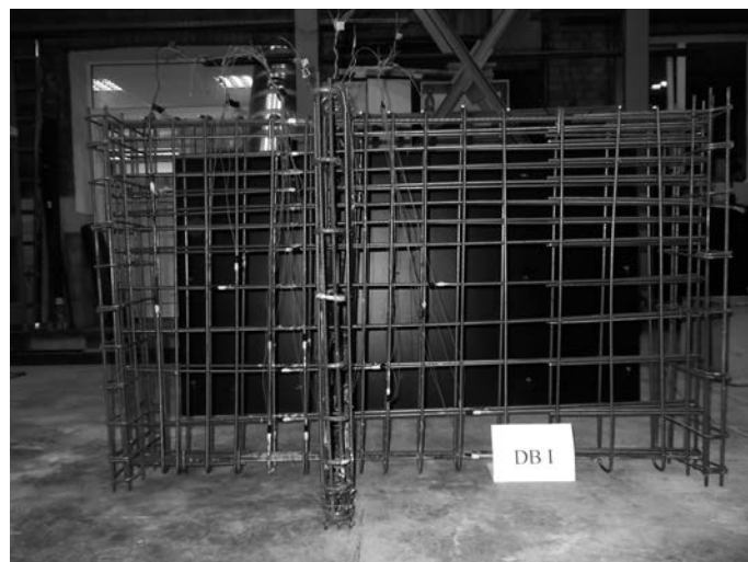
Rys. 3. Zbrojenie tarczy DB-I (zbrojonej ortogonalnie)
