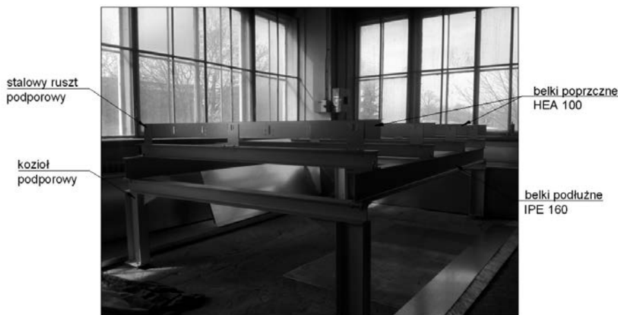
Rys. 3. Zdjęcie stanowiska badawczego z opisanymi elementami składowymi (fot. P. Lewandowski)
