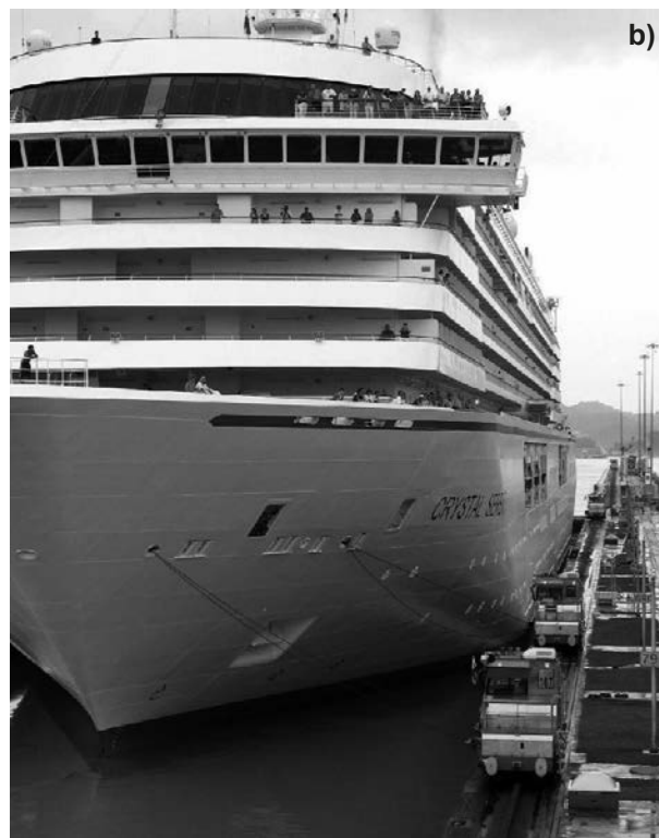
Rys. 7. Prowadzenie statków w śluzie holownikami, Śluza Północna w IJmuiden (a); lokomotywami, Śluzy Miraflores w Panamie (b)
