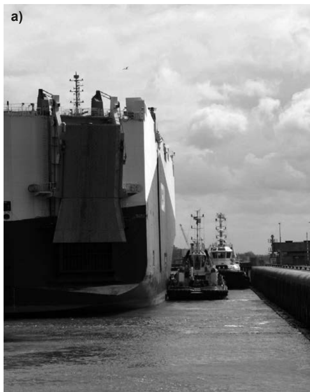
Rys. 7. Prowadzenie statków w śluzie holownikami, Śluza Północna w IJmuiden (a); lokomotywami, Śluzy Miraflores w Panamie (b)
