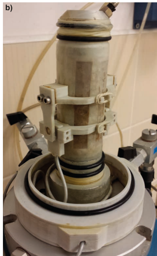
Rys. 1. Źródła błędów pomiarowych podczas pomiaru charakterystyki naprężenie – odkształcenie próbki (a) (według [2] zmienione) oraz czujniki naprębkowe (b)
