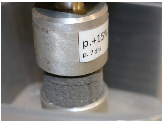
Rys. 2. Widok rozciąganej próbki z widoczną płaszczyzną zniszczenia
