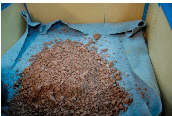
Rys. 3. Warstwa geosyntetyku w skrzyni stanowiska badawczego
