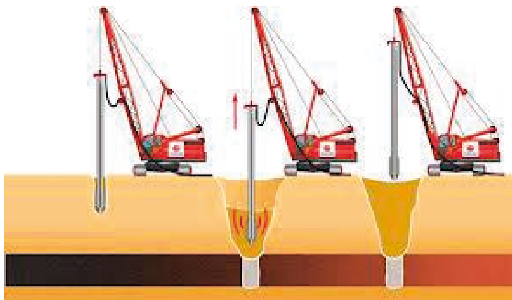
Rys. 2. Schemat wykonywania kolumn MMC
