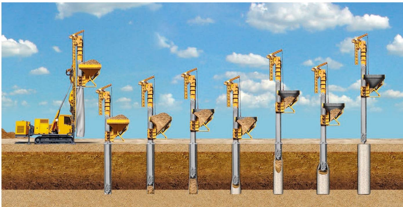
Rys. 4. Etapy wykonania kolumn z piasku w otoczce geosyntetycznej za pomocą wibroflota, system Keller
