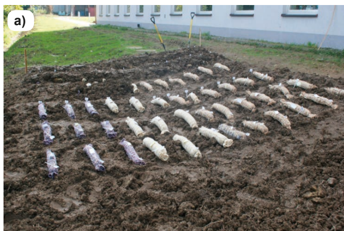
Rys. 4. Poletko doświadczalne do badań odporności sznurów Kemafil na biodegradację a) sznurki Kemafil przygotowane do zakopania, b) poletko po 6 miesiącach przed wykopaniem
