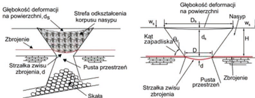
Rys. 4. Model obliczeniowy zbrojenia nadzapadliskowego według metody brytyjskiej BS 8006:1995, BS 8006:2010 [17]
