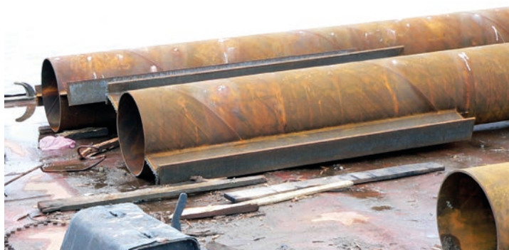
Rys. 9. Pal rurowy z przyspawanymi „skrzydełkami” wykonanymi z połówek dwuteowników
