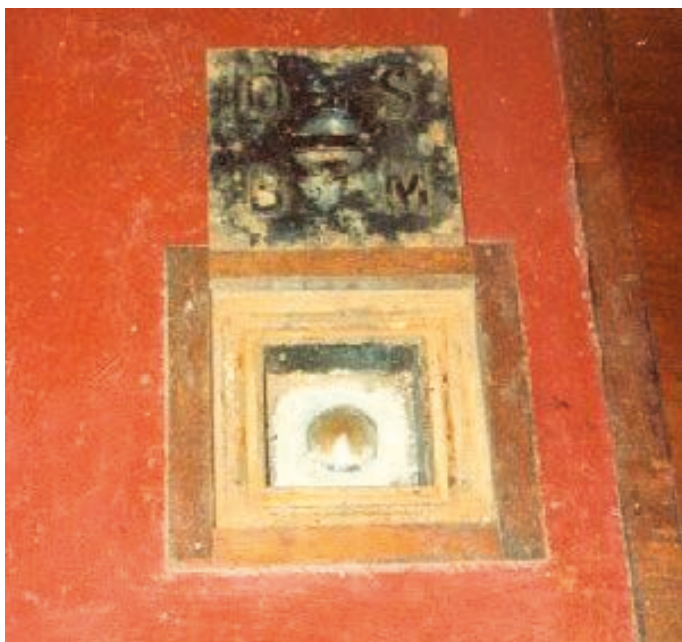
Rys. 6. Reper operacyjny zainstalowany w budynku Stacji Newlyn [31]
