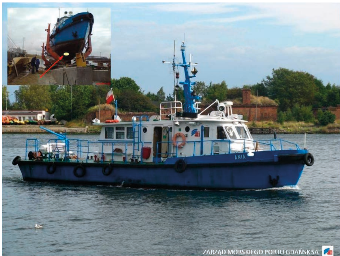
Rys. 1. Motorówka hydrograficzna „ANIA”, na zdjęciu jest pokazana również lokalizacja głowicy sondy wielowiązkowej EM3002
