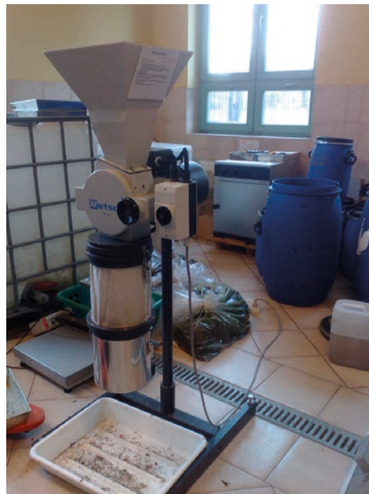
Rys. 1. Młynek tnący (Retsch SM100, Niemcy)
