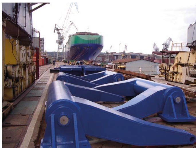
Rys. 10. Wykonane stalowe konstrukcje odbojowe przed wysyłką drogą morską do miejsca przeznaczenia
