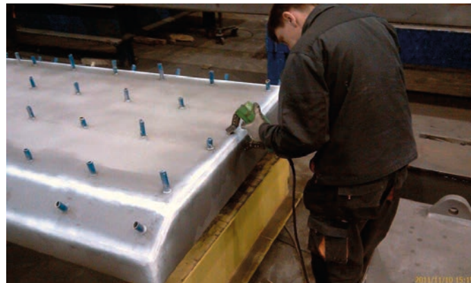
Rys. 4. Badania magnetyczno-proszkowe konstrukcji stalowej urządzenia odbojowego
