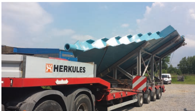
Rys. 9. Przygotowanie do transportu konstrukcji stalowej ponadgabarytowej systemu odbojowego
