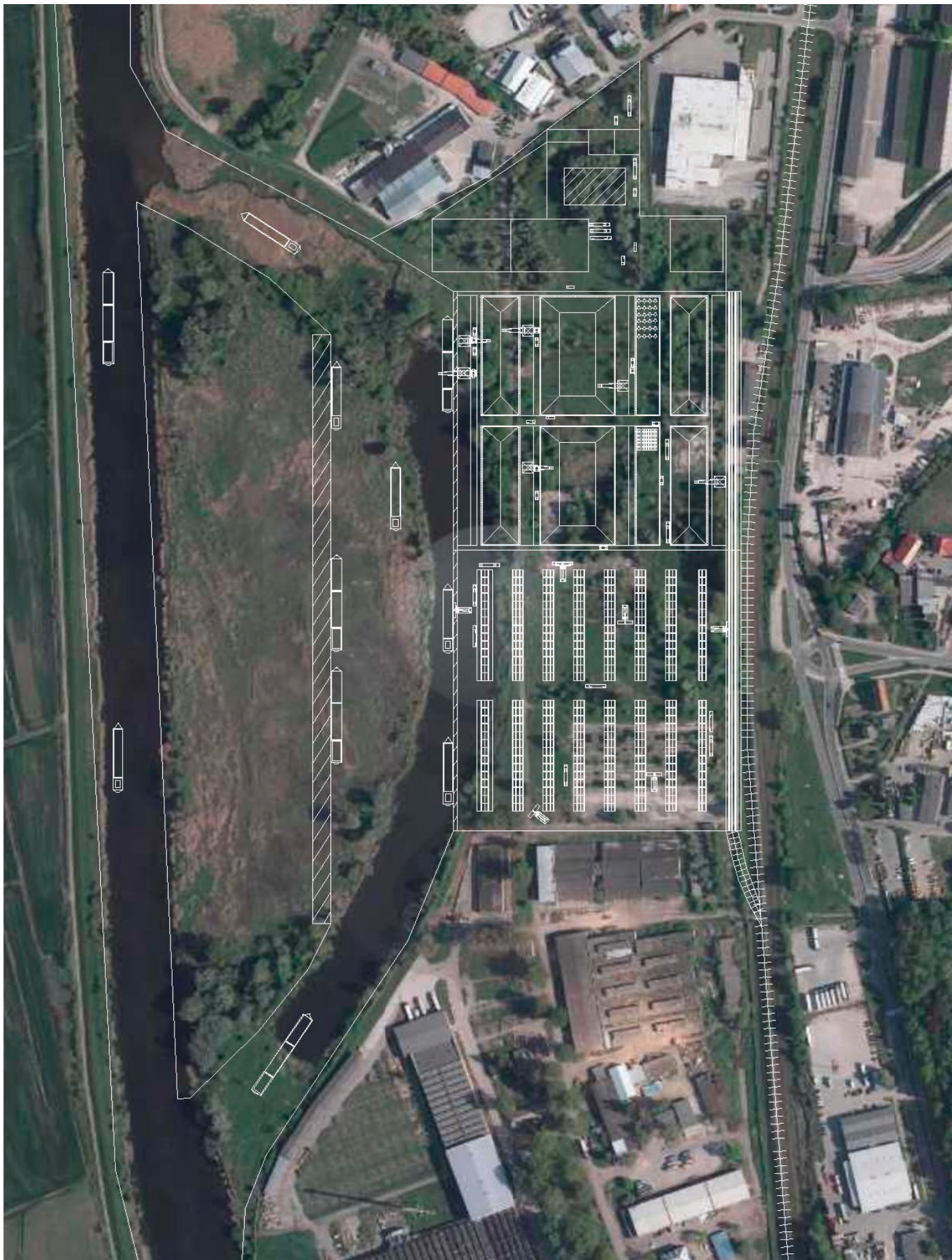
Rys. 11. Schemat koncepcji zagospodarowania nowego terminalu przeładunkowego w Elblągu – widok z góry. Opracowanie na bazie [9]
