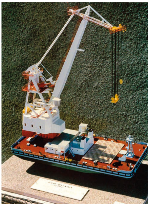
Rys. 1. Model żurawia pływającego o udźwigu 200 t, zbudowanego według projektu PROJMORS-u, opracowanego przez projektantów branży mechanicznej
