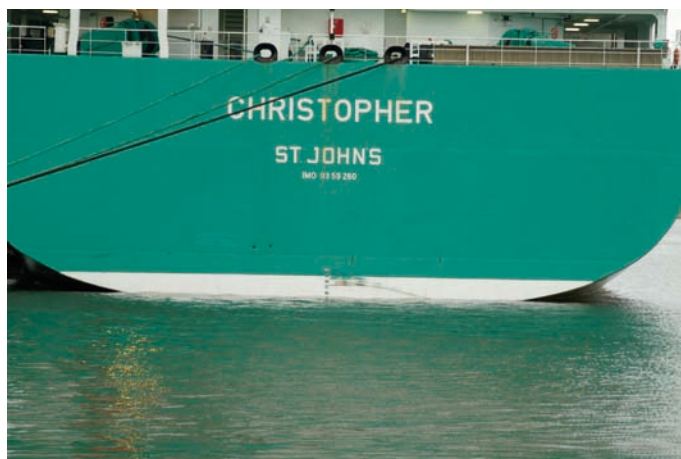
Rys. 8. Uszkodzenie powłoki ochronnej na rufie m/v CHRISTOPHER po uderzeniu statku w dalbę
