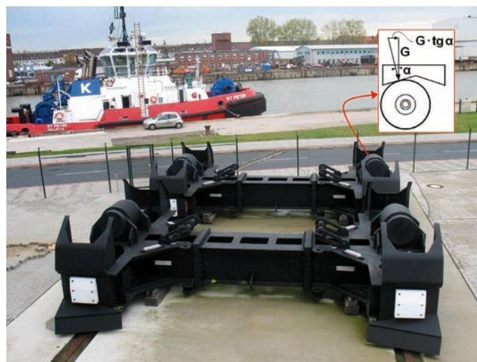
Rys. 10. Rezerwowe podwozia i zasada oparcia wrót na rolkach
