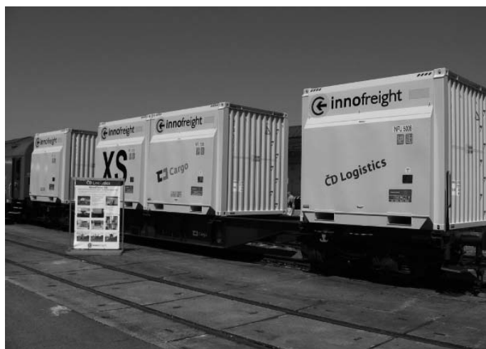
Rys. 4. Kontenery WoodTainer XS transportowane wagonami kolejowymi [8]
