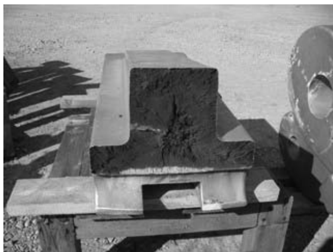
Rys. 3. Przełom elementu mocowania lin, czyli tzw. „krokodyla”
