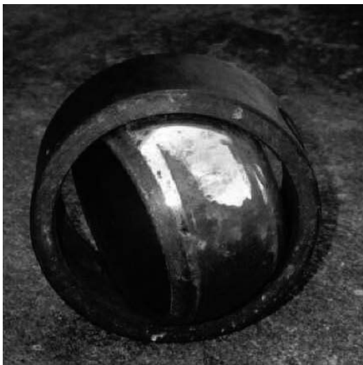
Rys. 10. Zużyte i nowe łożysko przegubu mocującego napęd wrót
