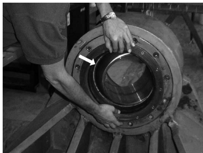
Rys. 4. Starta tuleja górnego łożyska (kulistego) wrót Śluz Orańskich w Amsterdamie
