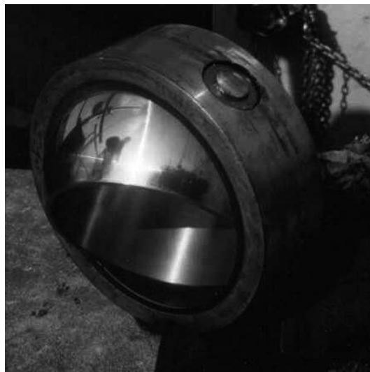
Rys. 10. Zużyte i nowe łożysko przegubu mocującego napęd wrót
