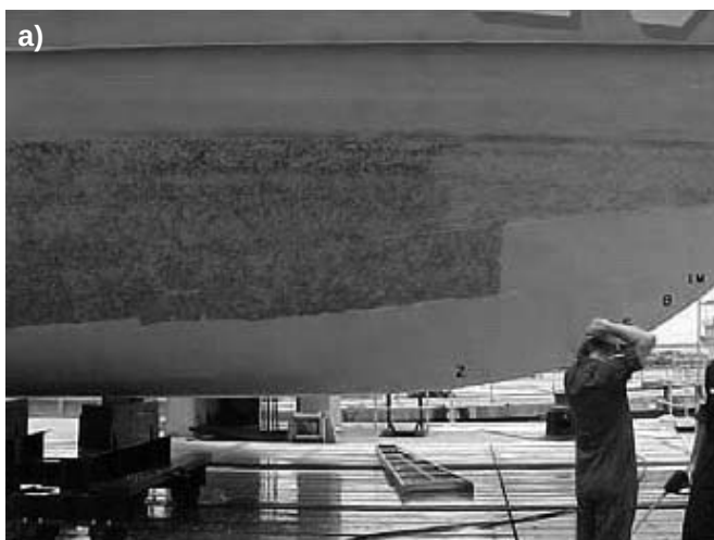
Rys. 6. Struktura warstwy porostowej powstałej na powierzchni kadłuba statku (opracowano na podstawie [5])
