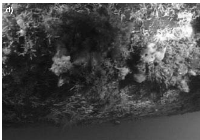
Rys. 7. Fazy porastania kadłuba statku (opracowano na podstawie [1] oraz [10]) a) śluz ( slime ); b) zielsko ( weeds ); c) bezkręgowce z twardą skorupą ( invertebrates with hard shells ); d) porost zupełny
