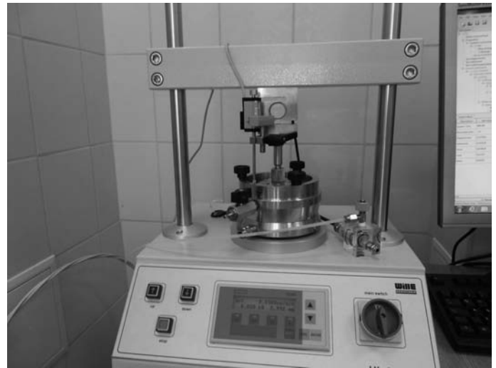
Rys. 2. Badanie ścisłości próbek gruntu w Laboratorium Katedry Geotechniki Zachodniopomorskiego Uniwersytetu Technologicznego w Szczecinie za pomocą prasy UL 25 Wille Geotechnik
