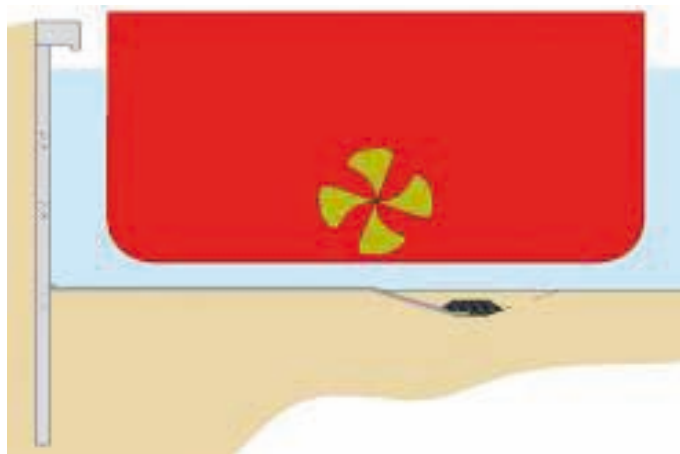
Rys. 24. Podmycie wywołane śrubą napędową
