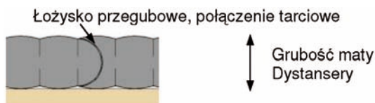
Rys. 2. CT – mata o stałej grubości
