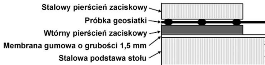
Rys. 5. Sposób mocowania próbki w zacisku pierścieniowym
