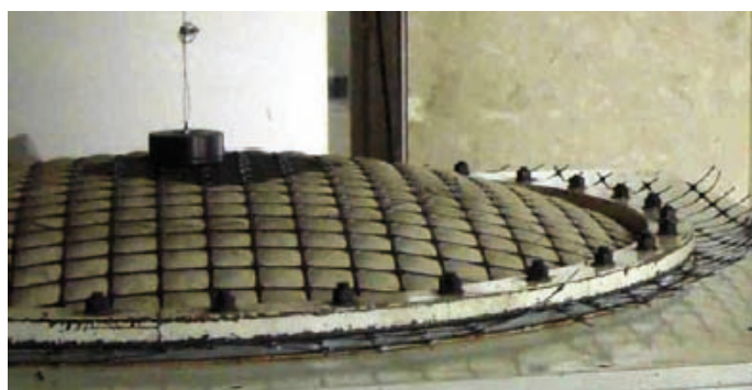
Rys. 7. „Puchnięcie” membrany poprzez oczka geosiatki przy wydłużeniu jednostkowym geosiatki wynoszącym 2%
