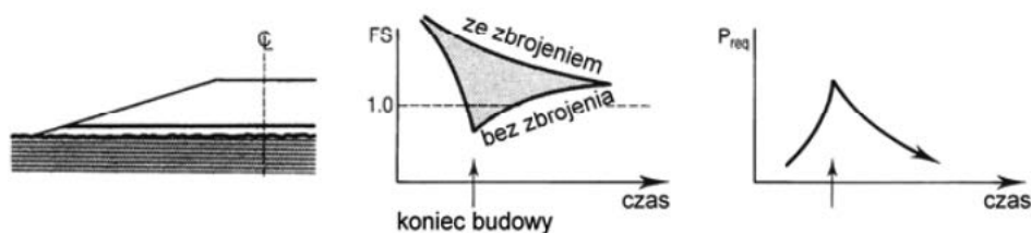
Rys. 2. Nasyp na słabym podłożu gruntowym ze zbrojeniem w podstawie [5]
