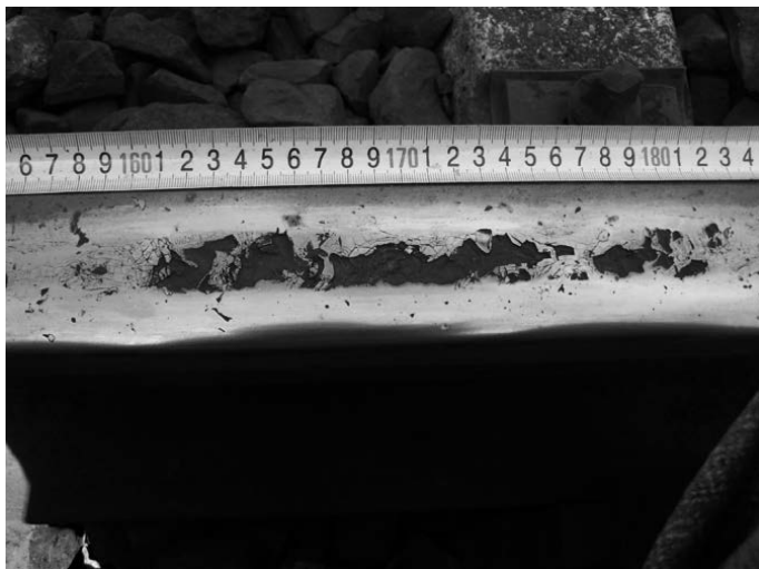
Rys. 1. Wada shelling powierzchni tocznej
