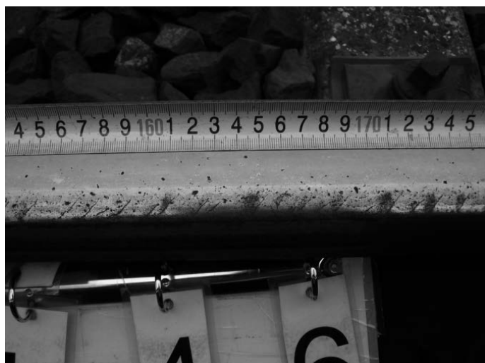
Rys. 4. Wada head check – rysy z zaciemnionymi zagłębieniami
