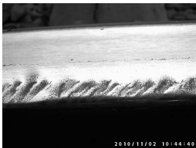
Rys. 14. Wady head check na powierzchni tocznej opornicy
