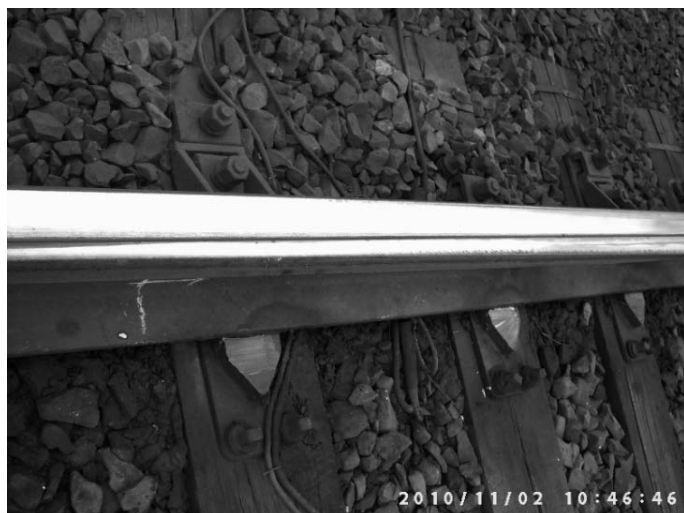
Rys. 15. Uszkodzenia head check na powierzchni tocznej iglicy prostej
