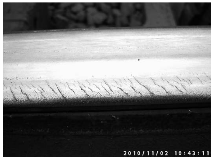
Rys. 12. Wady head check na powierzchni tocznej opornicy
