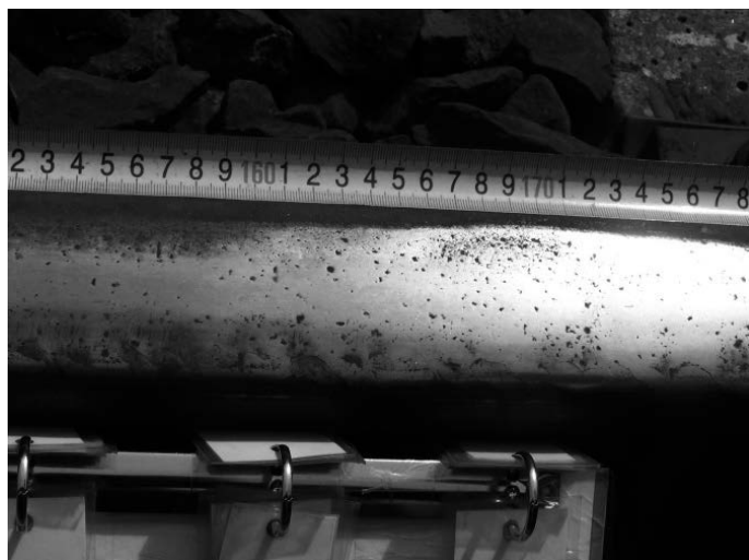
Rys. 3. Wada head check – rysy z powstającymi łuskami
