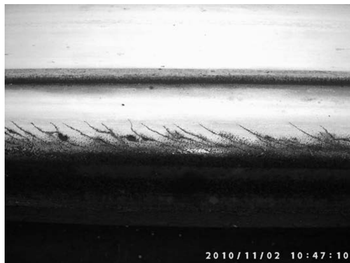
Rys. 15. Uszkodzenia head check na powierzchni tocznej iglicy prostej
