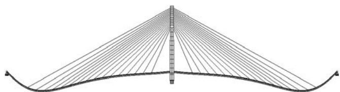
Rys. 6. Przemieszczenia pomostu przed i po naciągu want
