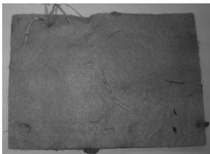
Rys. 6. Próbką geowłókniny jednowarstwowej po okresie 6 miesięcy
