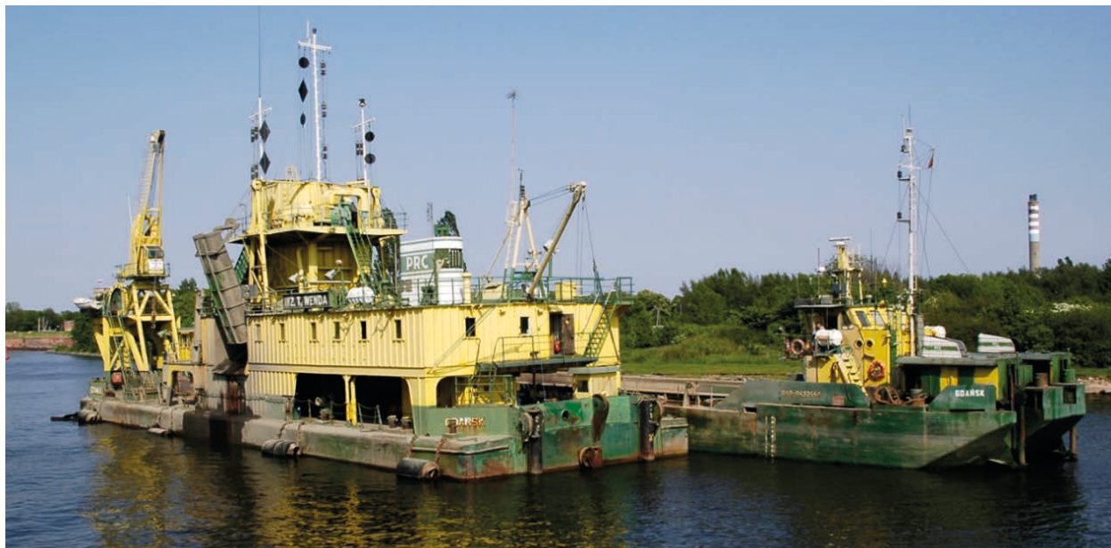
Rys. 1. Pogłębiarka wieloczerpakowa z przycumowaną szalandą w trakcie pracy na kanale portowym [10]
