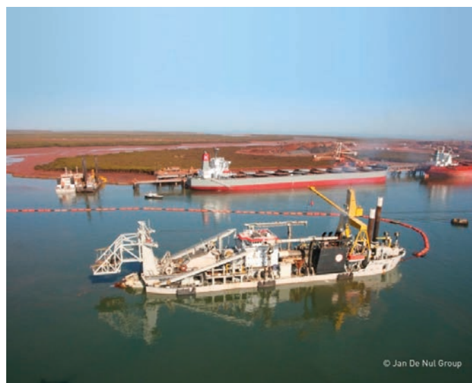
Rys. 3. Pogłębiarka ssąco-skrawająca z rurociągiem refulacyjnym pływającym w trakcie realizacji prac czerpalnych na obszarach portowych [10]
