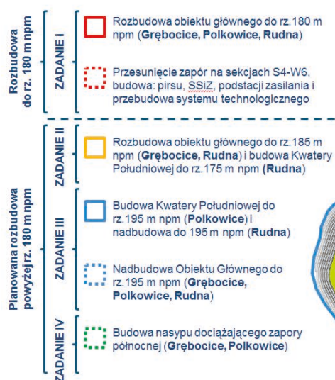
Rys. 3. Koncepcja rozbudowy OUOW Żelazny Most powyżej rzędnej 180 m n.p.m. Sposób deponowania odpadów [5]
