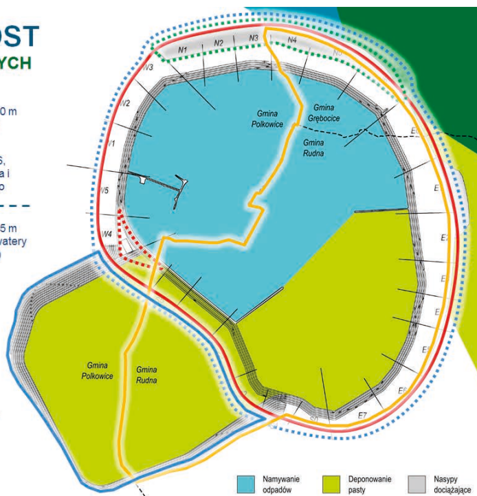
Rys. 3. Koncepcja rozbudowy OUOW Żelazny Most powyżej rzędnej 180 m n.p.m. Sposób deponowania odpadów [5]
