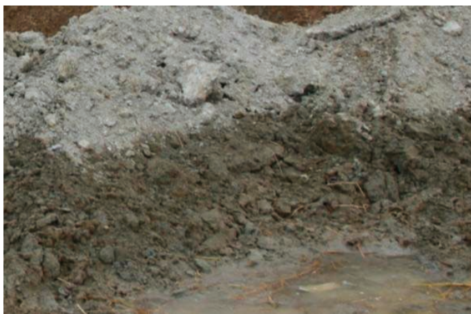
Rys. 5. Podciąganie kapilarne przemrożonego kompozytu łuowo-cementowego H_{kc} > 0,70 m
