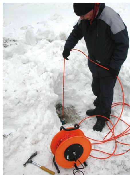
Rys. 7. Zerowy pomiar inklinometryczny (marzec 2006)
