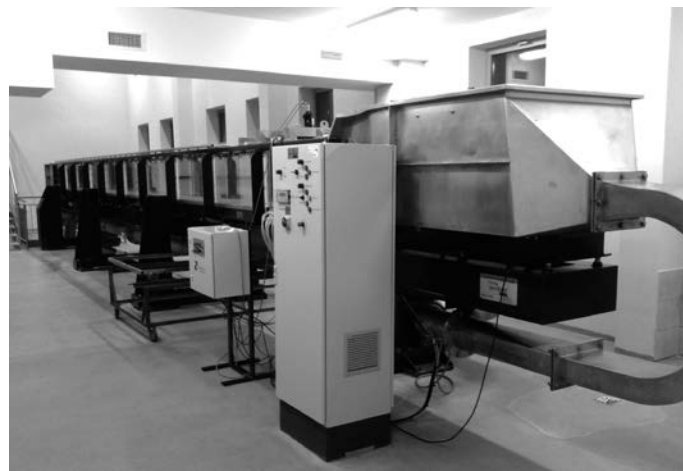
Rys. 1. Widok kanału rumowiskowo-przepływowego
