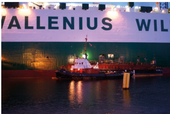
Rys. 6. Odbiór odpadów olejowych ze statku od strony wody (źródło: Przedsiębiorstwo COMAL Sp. z o.o. Gdańsk, Andrzej Czerwicki)
