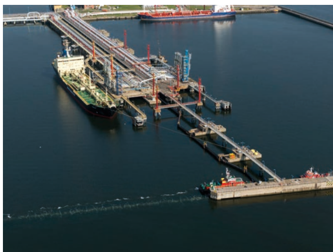
Rys. 8. Zapora pneumatyczna podczas przeładunku paliw (źródło: www.portgdansk.pl , Kacper Kowalski)
