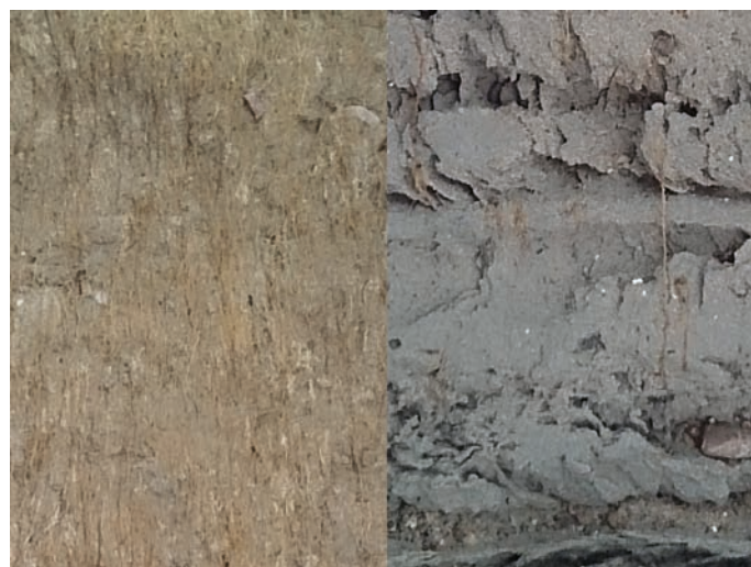
Rys. 16. Penetracja korzeni w nieporośniętej powierzchni skarpy. Korzenie zaklinowane w gruncie (warstwa gliny po lewej), brak ukorzenienia (mieszanina piasku i popiołu po prawej). Kanał 2, sekcja 1 i 4 (nieporośnięty)
