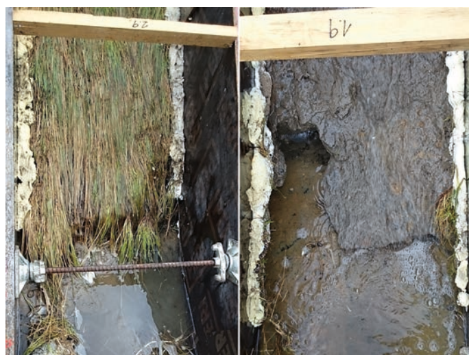
Rys. 17. Stopa wału na warstwie gliny – powierzchnia poślizgu pomiędzy gliną i mieszaniną piasku i popiołu. Sekcja 9 kanału 1 (po prawej) i kanału 2 (po lewej) po piątym etapie badań (porośnięty)
