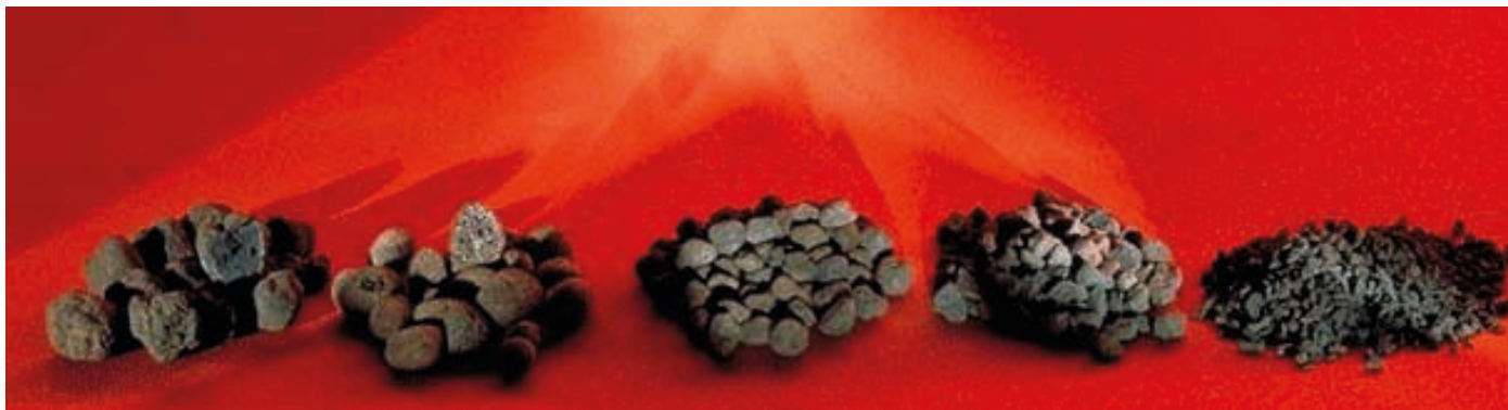
Rys. 2. Próbkę „Filtralite” zróżnicowaną w zakresie wielkości, kształtu i gęstości [20]
