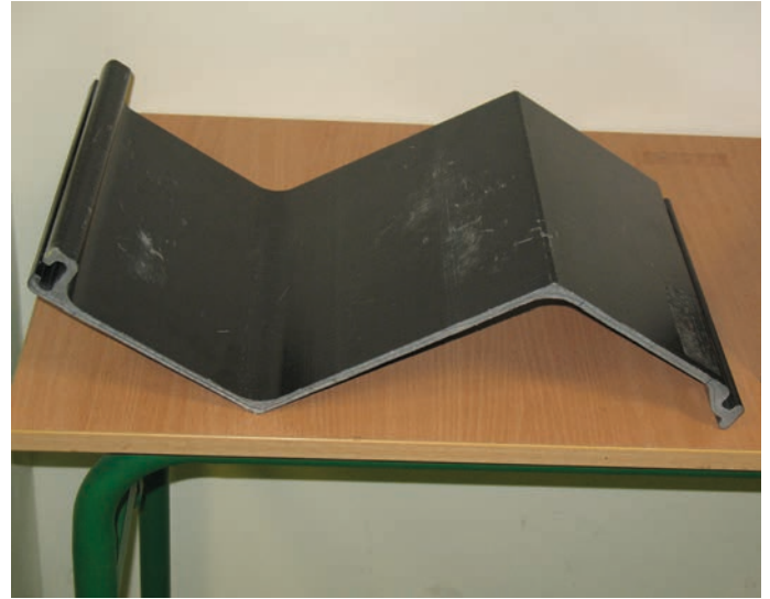
Rys. 3. Model kompozytowej grodzicy (brusa) ścianki szczelnej produkcji firmy LeeComposites Inc. (USA)
