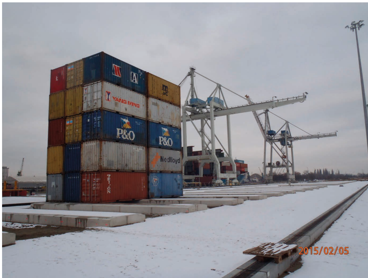
Rys. 7. Obciążenie próbne w warunkach eksploatacji
