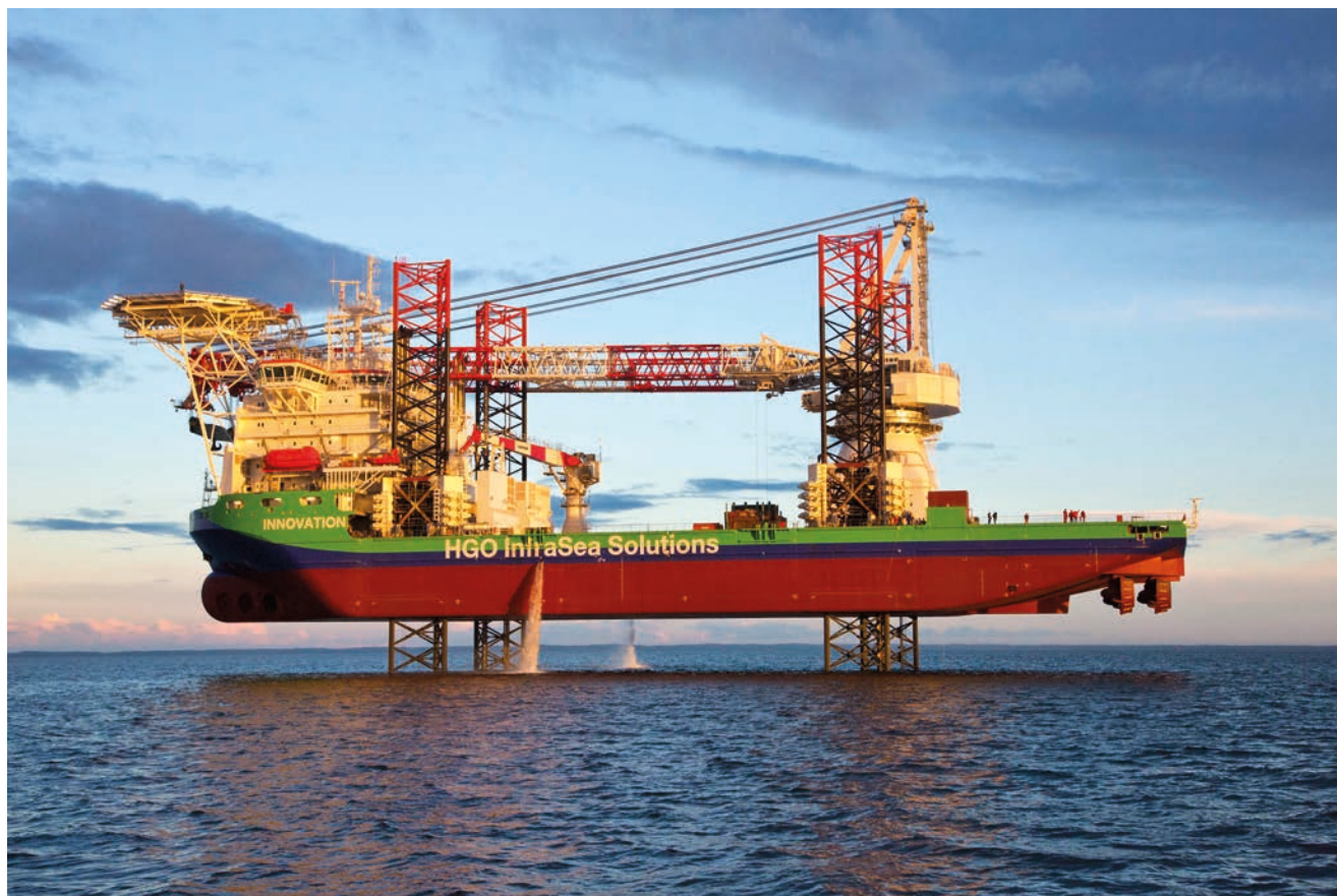
Rys. 3. Jednostka HLJV Innovation na Zatoce Gdańskiej po podniesieniu na 8 m n.p.m.
