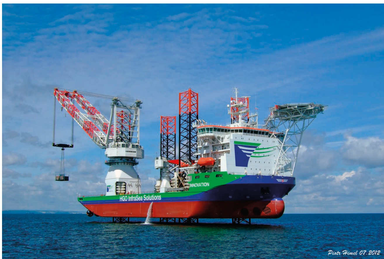
Rys. 4. Jednostka HLJV Innovation na Zatoce Gdańskiej w trakcie prób dźwigu (fot. za zgodą Autora)
