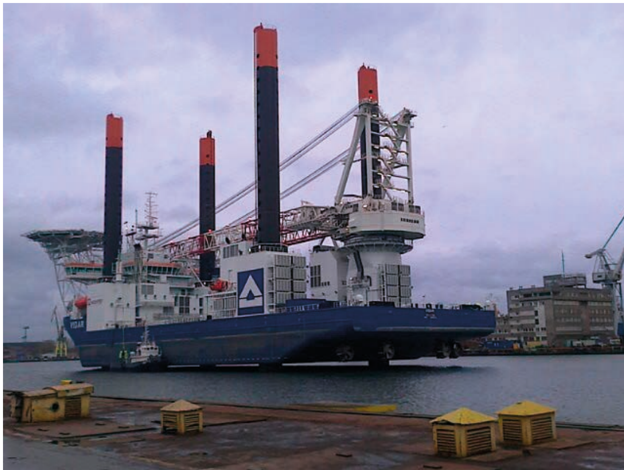
Rys. 7. Jednostka HLJV Vidar w trakcie prób podnoszenia w Basenie VII Portu Gdynia
