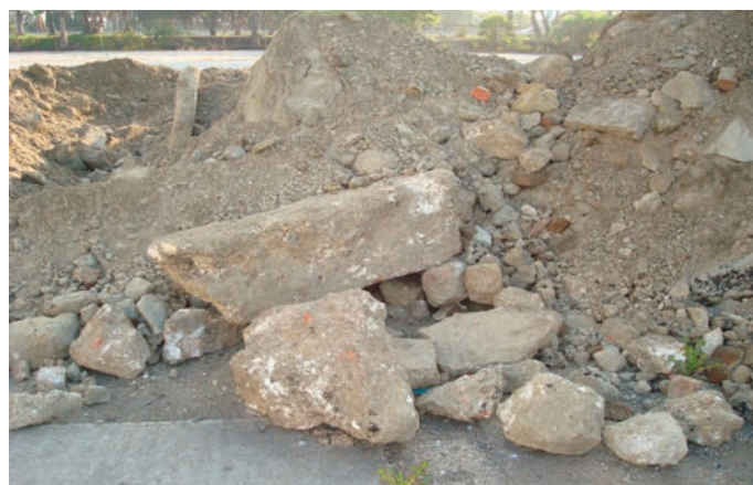
Fig. 2. Construction Rubble Fill
