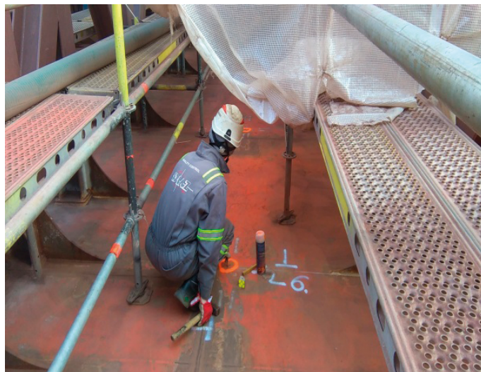
Rys. 4. Tarczki foliowe (tzw. znaczki celownicze) stosowane jako punkty pomiarowe podczas budowy kadłubów statków
