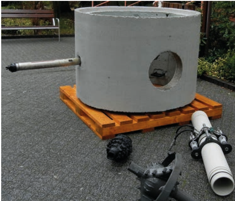
Rys. 3. Komora (studzienka rewizyjna) służąca do bezwykopowego wprowadzania rurociągów o mniejszych średnicach Po prawej stronie przykład prawidłowo wykonanego otworu w ścianie betonowej
