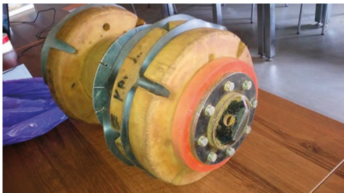
Rys. 3. Widok czyszczaka używanego do kontroli rurociągu paliwowego
