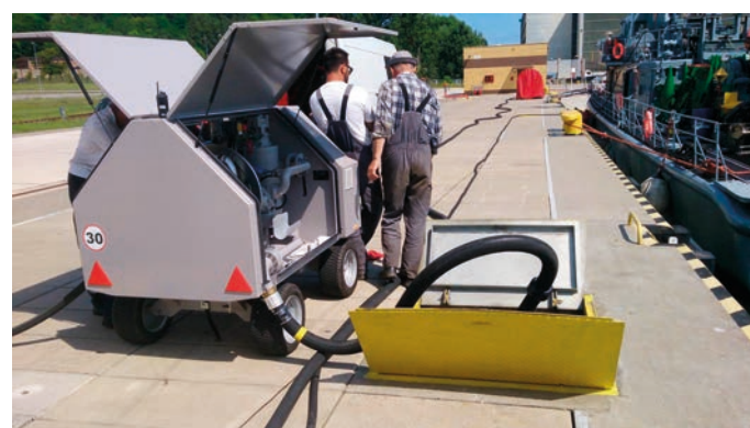
Rys. 9. Przewoźna stacja pomiarowa (wózek pomiarowy) przeznaczona do zaopatrzenia w paliwo małych okrętów
