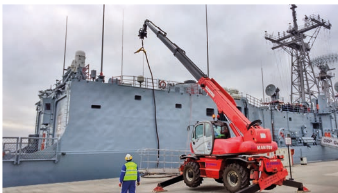
Rys. 11. Dźwig samojezdny Privilege podtrzymujący wąż paliwowy przed podłączeniem do manifoldu na okręcie
