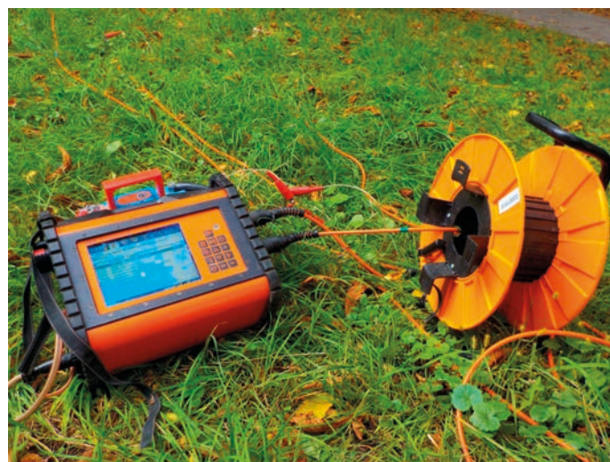
Rys. 3. Aparatura do tomografii elektrooporowej TERRAMETER LS 8 ch. (prod. ABEM, Szwecja)
