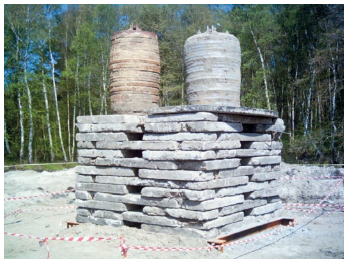
Rys. 6. Obciążenie kolumn z kruszywa
