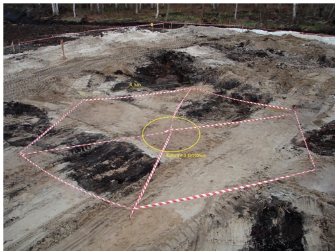
Rys. 4. Kolumna badana w otoczeniu sześciu kolumn wzmocniających
