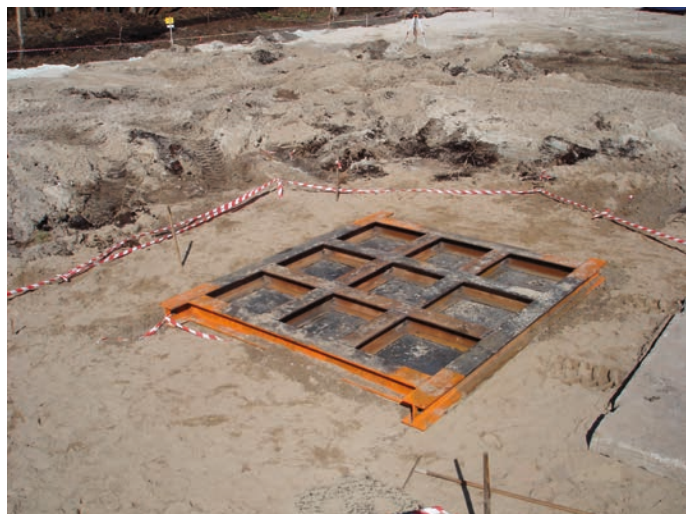
Rys. 5. Podstawa konstrukcji obciążającej kolumnę z kruszywa
