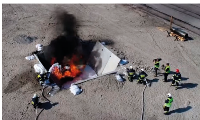
Rys. 2. Ogrzewanie zbiornika z LNG [10]
