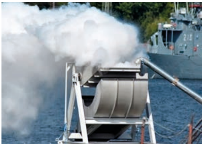
Rys. 6. Zbiornik przeznaczony do RPT (opracowanie własne)
